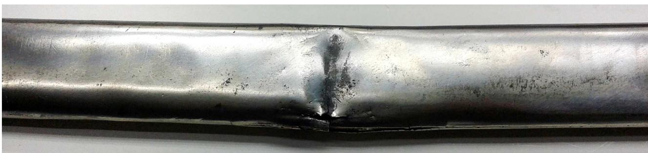
Да еще вдобавок там имели место прорывы и трещины металла, образовавшиеся после неумелой рихтовки, и следы электросварки.
